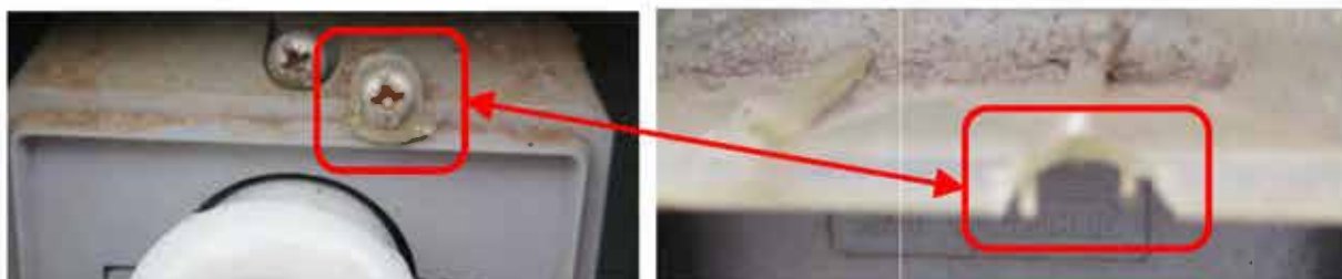
Obr. 7.12 Ulomené časti krytu stožiarovej rozvodnice GURO EKM 2035 1xE27 (E005) na Bazovského ul.
