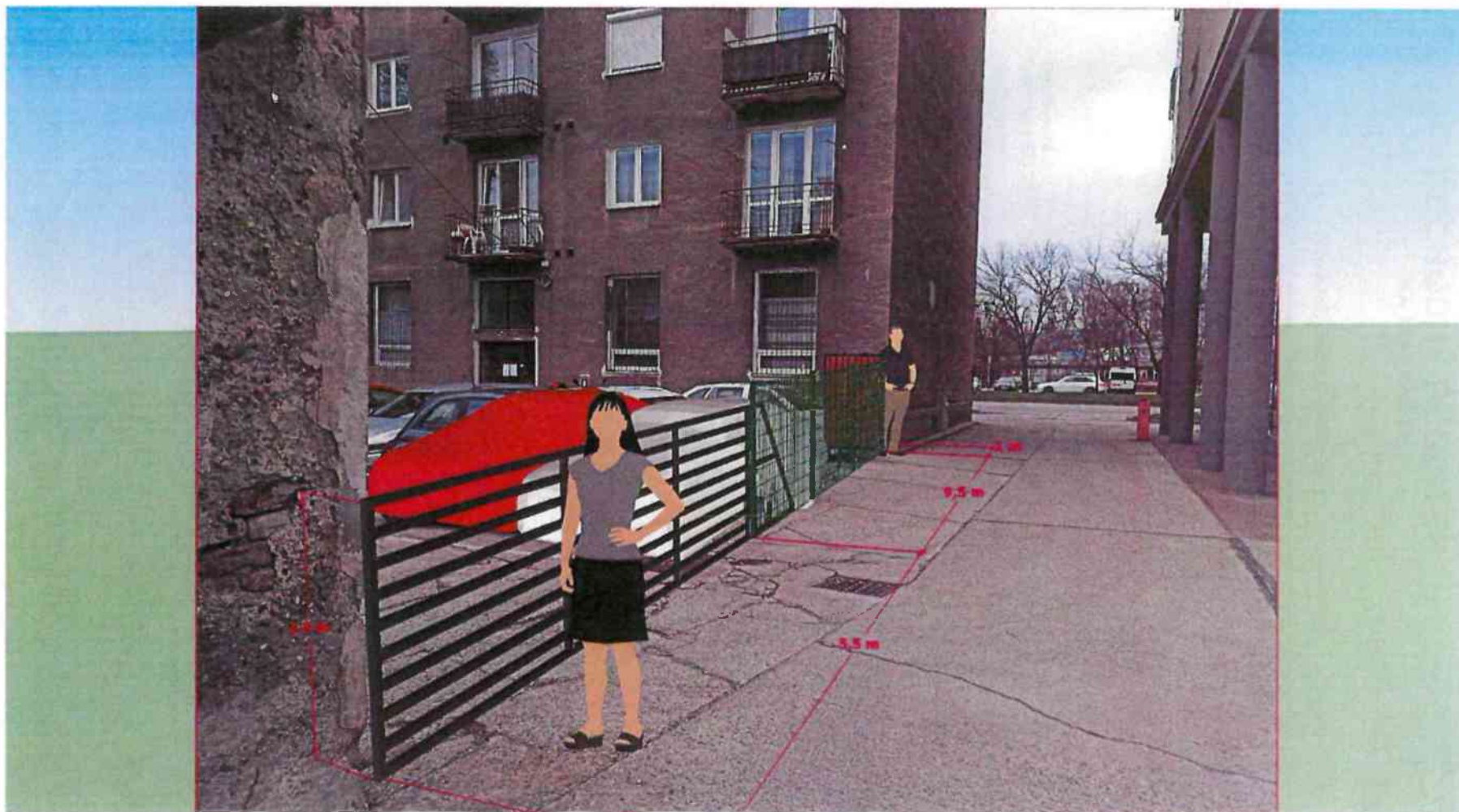
Návrh samonosnej zasúvacej brány a oplotenia.
