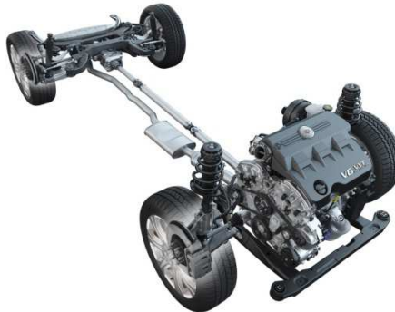
Obr. 5. - Základná konštrukcia vozidla so spaľovacím motorom, Ilustrácia: General Motors
